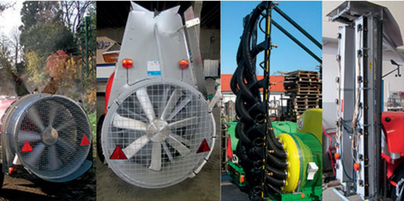
Abb. 216 Gebläsetypen (von links nach rechts): Axial, Axial mit Querstromaufsatz, Radial mit Schläuchen zur Luftverteilung und Tangential.
